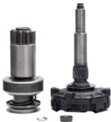
**Passo 5:** Efetue uma pequena lubrificação nas estrias do eixo da planetária. Introduza o impulsor até o final das estrias, retire novamente e mude de posição pulando uma estria afim de melhorar a lubrificação.
